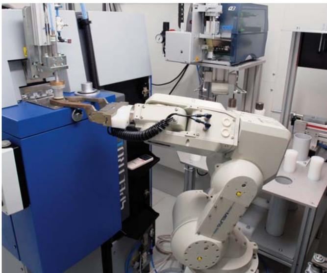
Das Containerlabor vom Typ Nucleus ist ein vollautomatisches Qualitätskontrollsystem für kleinere und mittlere Stahlwerke ohne zentrales Prüflabor. Es wird nahe der Produktion im Werk betrieben und anschlussfertig vorbereitet geliefert. Der automatisierte Ablauf umfasst sämtliche Schritte von der Anmeldung und dem Transport der Proben über deren Aufbereitung bis zur Analyse. Die Probenzuführung, die Robotersteuerung und die Statusüberwachung erfolgen über ein rechnergestütztes Leitsystem.
