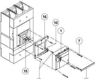
Auf den Leistungsschalterdeckel die Befestigungsplatte (16) mittels der Schrauben (10) und (12) montieren (siehe Vorbereitungsvorgänge). Den Antriebssatz (1) montieren, dabei darauf achten, dass der Bedienungs-Kipphebel (15) sich in die Gabel des Hebels (17) einfügt. Alles durch die Schrauben (7) sperren (Anzugsmoment = 1,5 Nm).
