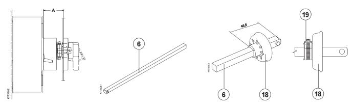
Nach der Montage des Antriebssatzes (1) muss die Abmessung "A" festgelegt werden. Danach den Verlängerungsstab (6) abschneiden, dessen Länge ist gleich: A + 2 mm.
