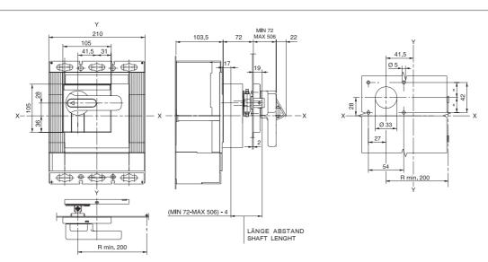
Die Bohrung der Schaltfeldtür laut den auf der Skizze angegebenen Maßen ausführen (oder mit Schablonenschild von Pos. 9).
