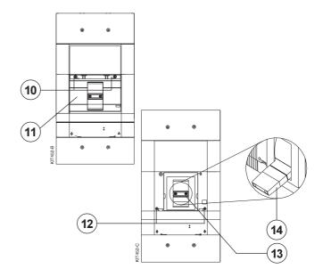
Den Leistungsschalter ausschalten (Bedienungs-Kipphebel in Position "O").
