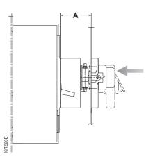
Den Leistungsschalter ausschalten, den durch den Pfeil angezeigten Punkt drücken und die Vorhängeschlösser einhängen (bis zu drei Vorhängeschlösser des Kunden - maximaler Schaftdurchmesser 6 mm).
