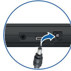
Das Gerät darf nur mit dem mitgelieferten Netzteil und/oder dem mitgelieferten Akku betrieben werden. Das externe Netzteil darf nicht abgedeckt werden (Überhitzungsgefahr).
