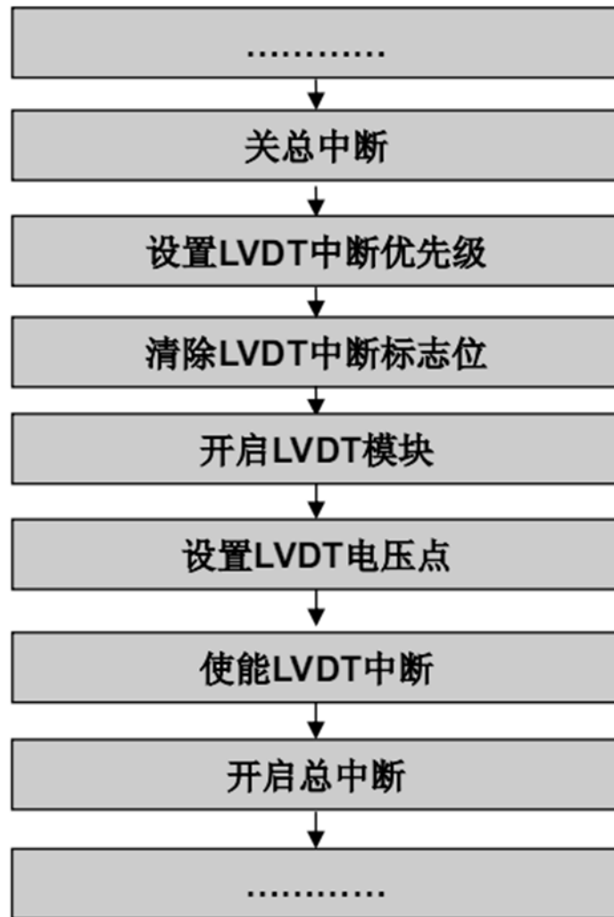
LVDT 低电压检测配置流程
