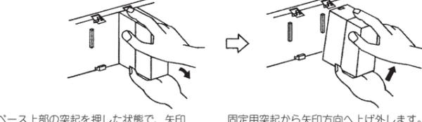
ベース上部の突起を押しした状態で、矢印方向へ引き外します。
